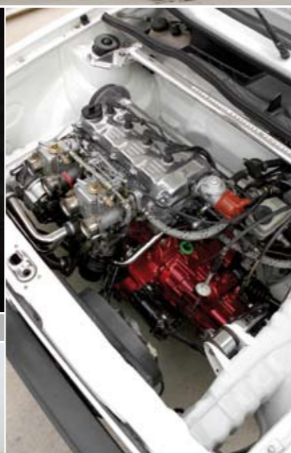
DE 1,9 LITER VAN KRONENBURG MOTOR MET 45 MM WEBERS LEVERT MINIMAAL 192 PK.
