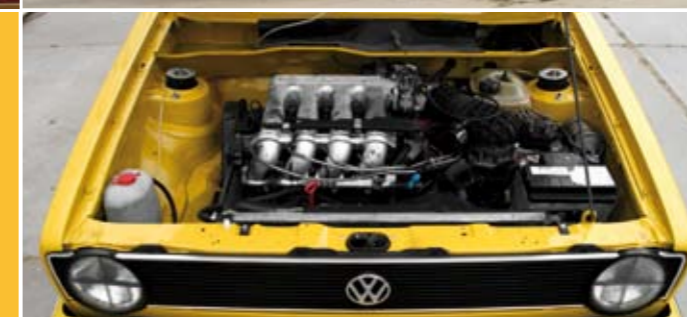
HET SCIROCCO 1.8 16V-BLOK ADEMT VRIJ DOOR EEN ENKELE LANGE PIJP MET EEN POWER-SPRINT EINDDEMPER.
