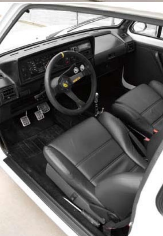
MAGISTRAAL MOOI K-TECH SCHAKELMECHANISME EN ELEKTRISCHE VERSTELBARE RECARO'S.
